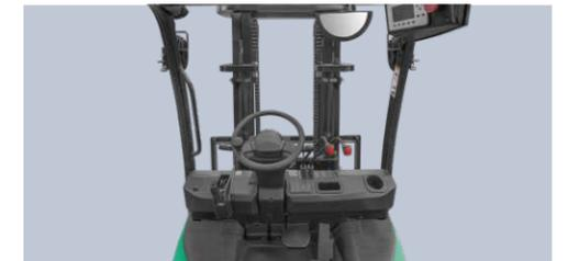
Das Weitsicht - Hubgerüst ist so orientiert, dass es die Sicht möglichst wenig behindert wird. Auch die verbreiterte Öffnung des Gabelträgers wirkt in diesem Sinn.
